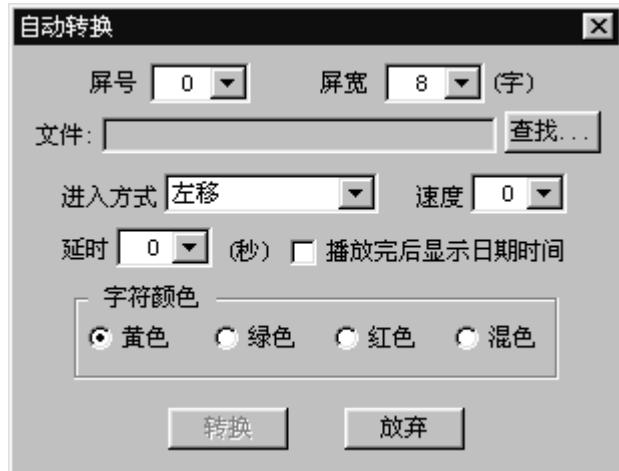
按照提示要求的设定好条屏的屏号、宽度，查找到要转换的源文件，所有节目都将设置为统一的进入方式、速度、延时、时间显示状态、文本颜色。点击[转换]按钮，程序将自动开始转换工作，然后会提示是否打开转换的结果。
