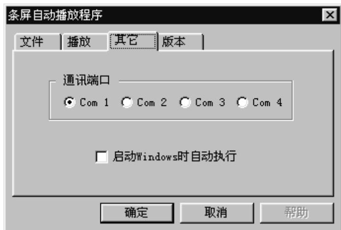
该窗口设定通讯时使用哪个计算机串行口，以及在计算机启动时是否自动加载本自动播放程序。
