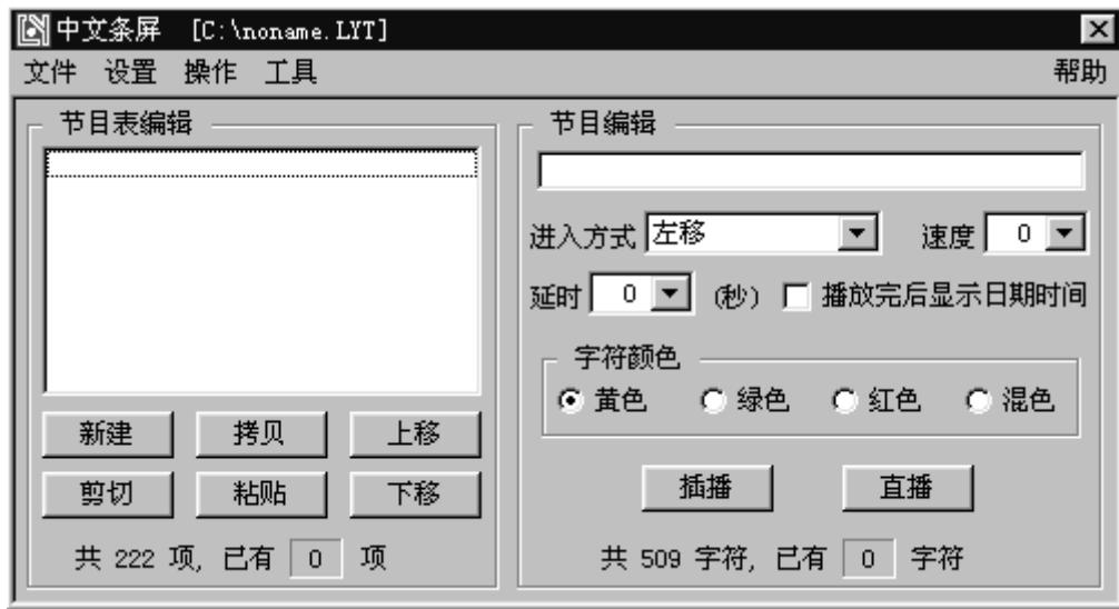
界面左边是对节目表的操作，可以通过下面的按钮在节目表中新建一个节目项，或对已有的节目项进行剪切、拷贝、粘贴、上移或下移。按钮下方是条屏控制卡上可存储的节目项的空间使用状态。
