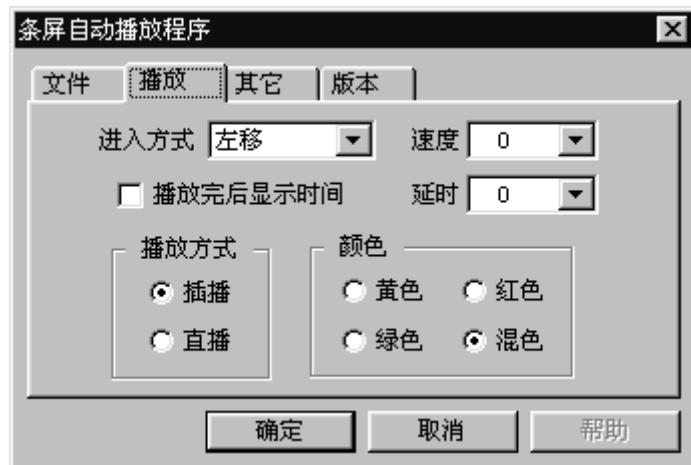
该窗口设定播放方式。在自动播放程序的控制下，所有发送到条屏上的节目，都是采用相同的播放方式和字符颜色。
